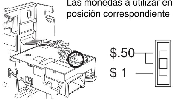
Las monedas a utilizar en el tubo E, se seleccionan deslizando el switch a la posición correspondiente a \$0.50 o \$1.00.
